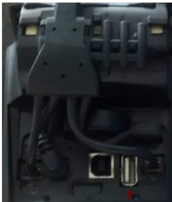
**OBS.: Para esse modelo de POS não é necessário a utilização de adaptadores, bastando apenas inserir o pen drive na porta USB convencional que se encontra na parte traseira do equipamento.**
